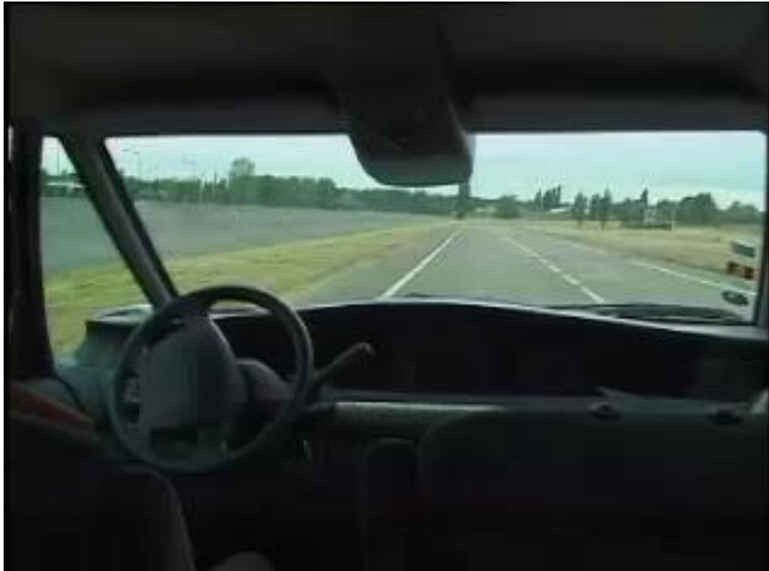
**Boucle robotique classique et assez simple : asservissement commande du volant selon estimation position par rapport à route**
